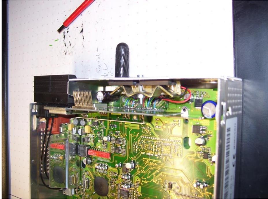
Mit einer Schraube und einem CNC-gefertigtem Spezialblech ;- ) werden die TDA's an der Gehäuse-Rückwand fixiert. Zwischen Gehäuse und TDA etwas Wärmeleitpaste geben!
