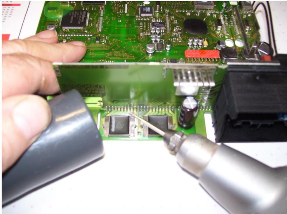
**Mit Stabschleifer und Staubsauger die Vergußmasse entfernen bis die Leiterbahnen stellenweise zu sehen sind**
